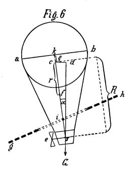
wie dies die Figur darstellt, durch den Schwerpunkt gehend, so ist die von d nach e übertragene Spannkraft =  $Q \cdot \sin \alpha$ . Besände sich aber die Flügelwelle oberhalb des Schwerpunktes s, also etwa in f, und bezeichnen wir cf = r, so wäre allgemeiner die von d nach f übertragene Kraft =  $\frac{R}{r}$  G sin  $\alpha$ , und wenn v die Geschwindigkeit des Ballons bedeutet, die wegen Schiefstellung desselben verrichtete Arbeit =
