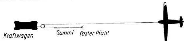
Abb. 16. Kraftwagenstart mit Umlenkrolle
