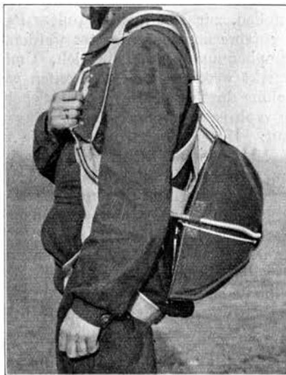
Abb. 73. Der Rettungsring des Segelfliegers, der Fallschirm. Der hier gezeigte Schirm ist eine Ausführung der Firma „Autoflug“, Berlin. Das Fallschirmpaket (Rückenfallschirm) ist relativ klein, die Schirme sind aus Seide und dementsprechend leicht und werden manuell (von Hand) ausgelöst (siehe die rechte Hand des Piloten!).
