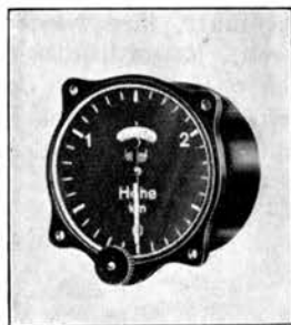
Abb. 69. Höhenmesser für Segel- und Motorflugzeuge
