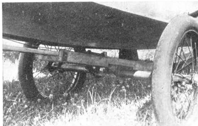
Abb. 33. Abwerfbares Fahrgestell, das einen sehr schnellen Start auch mit leichten Zugflugzeugen ermöglicht. Sobald die Segelmaschine fünf Meter hoch ist, klinkt der Führer das Fahrgestell aus
