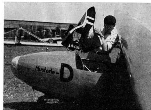
Abb. 75. Die praktische Instrument- und Windschutzhaube Wolf Hirths an seinem Flugzeug „Musterle“. Nach Abnehmen des Instrumentendeckels kann für den Transport ein abschließbarer Führersitzdeckel eingesetzt werden
