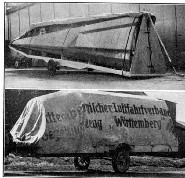
Abb. 86. Moderne Segelflugzeugtransportwagen. Rahmen mit Plane
