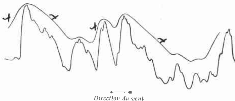
Fig. 29. — Trajectoire d'un avion voilier utilisant les rafales d'un vent horizontal de 8 m. 50 de vitesse maxima.
