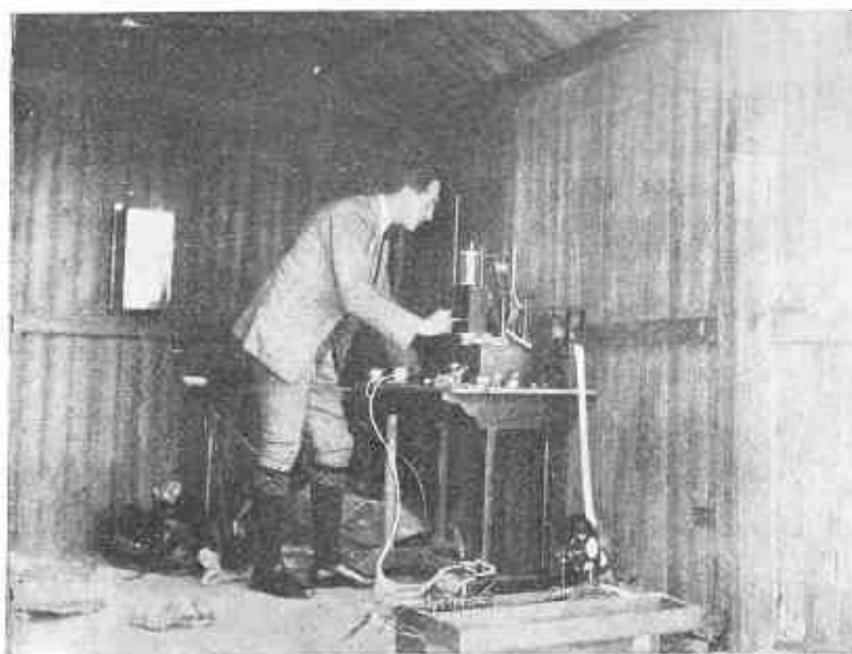
Fig. 6. — Cabine d'expérience pour l'étude des vents marins et appareils enregistreurs de la vitesse instantanée du vent
