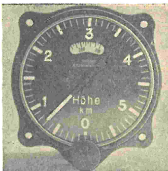
Abb. 38: Grobhöhenmesser (Anzeige 700 m)
