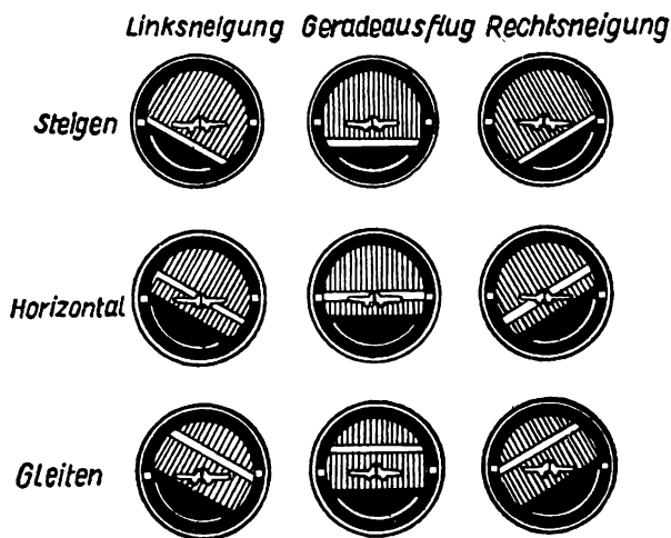
Abb. 47: Anzeigestellungen des künstlichen Horizontes bei verschiedenen Fluglagen
