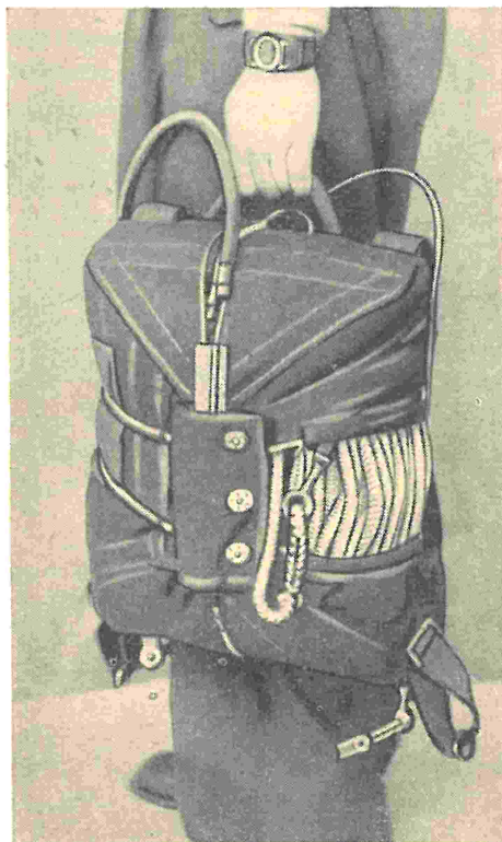
Abb. 151: Grundsätzlich wird der Fallschirm am Handgriff getragen. Niemals am Gurtzeug tragen, da sich dann die Fangleinen herausziehen
