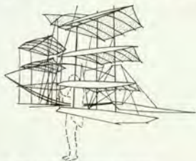
16. ábra. Chanute többszárnyú siklógépe
