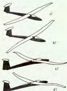
192. ábra. A szárny aszimmetrikus rezgése kiegyensúlyozatlan csűrő esetén
