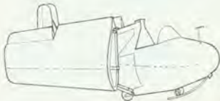
145. ábra. Az R-16 Lepke szárnyai a tároláshoz hátracsukhatók voltak
