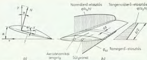
172. ábra. a) A légerők felbontása tangenciális és normálerekre; b) a szárny terhelésének feszítávolság menti eloszlása
