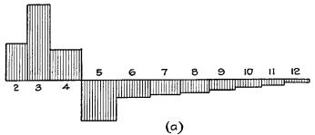
SHEAR DIAGRAM FORTEN TIMES THE FUSELAGE WEIGHTS
