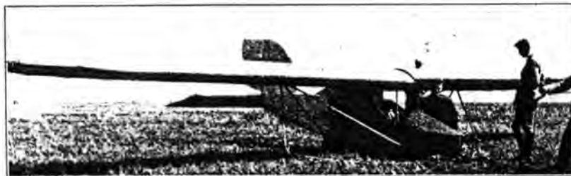
Fig. 91. Dresden-Eindecker 1922. Flügelgesteuertes Rumpfflugzeug.
