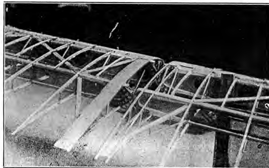
Fig. 24. Flügel-Anschluß des Darmstadt-Eindeckers „Edith“ 1922. Zweiholmige Bauart.
