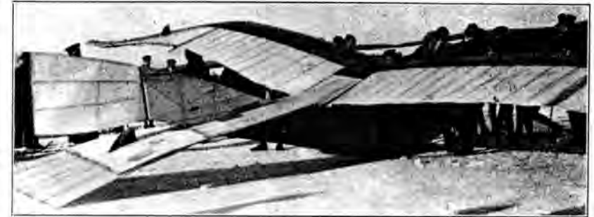
Fig. 63. Zeise-Nesemann-Eindecker „Senator“ 1923. Elastische Taubenflügel mit Sperrholznase. Sperrholzrumpf. Mittelkufe.
