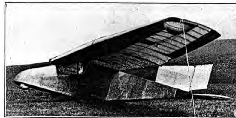
Fig. 80. Hannover-Eindecker „Vampyr“ 1921. 1. Ausführung mit Quersteuerungsklappen und seitlichen Schutzbällen.
