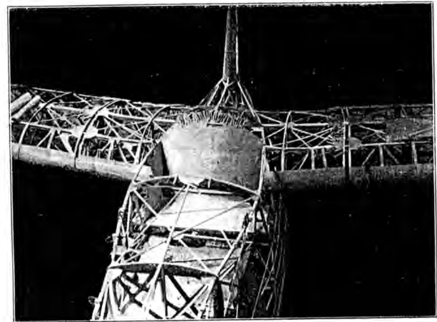
Fig. 23. Flügel- und Rumpferippe der Klemperer-Ente (Aachen) Zweisitzer.
