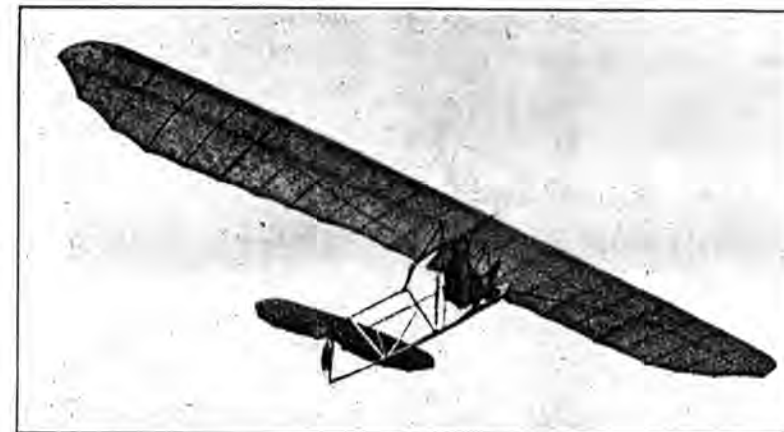
Fig. 92. Harth-Messerschmitt-Eindecker S. 10 1922. Flügelgesteuertes Flugzeug mit Gitterrumpf.
