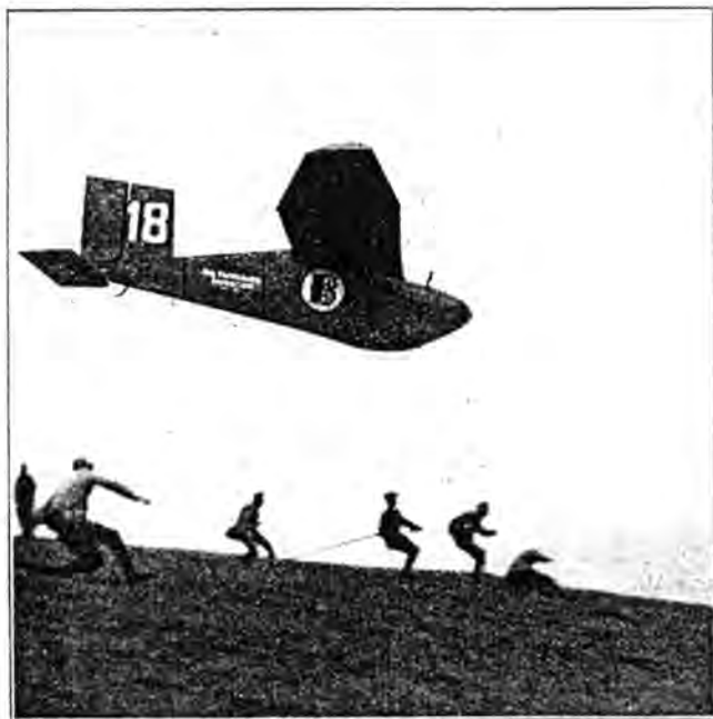
Fig. 40. Darmstadt-Eindecker „Geheimrat“ beim Start. Das Startseil ist gefallen, das Flugzeug übersteigt die Startmannschaft
