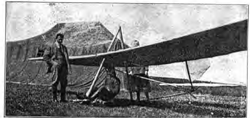
Fig. 20. Moebius-Pocher-Eindecker 1922. Verspannter, leichter Sitzgleiter zu Übungs- und Sportzwecken. Geringe Baukosten. Leicht zusammenlegbar.
