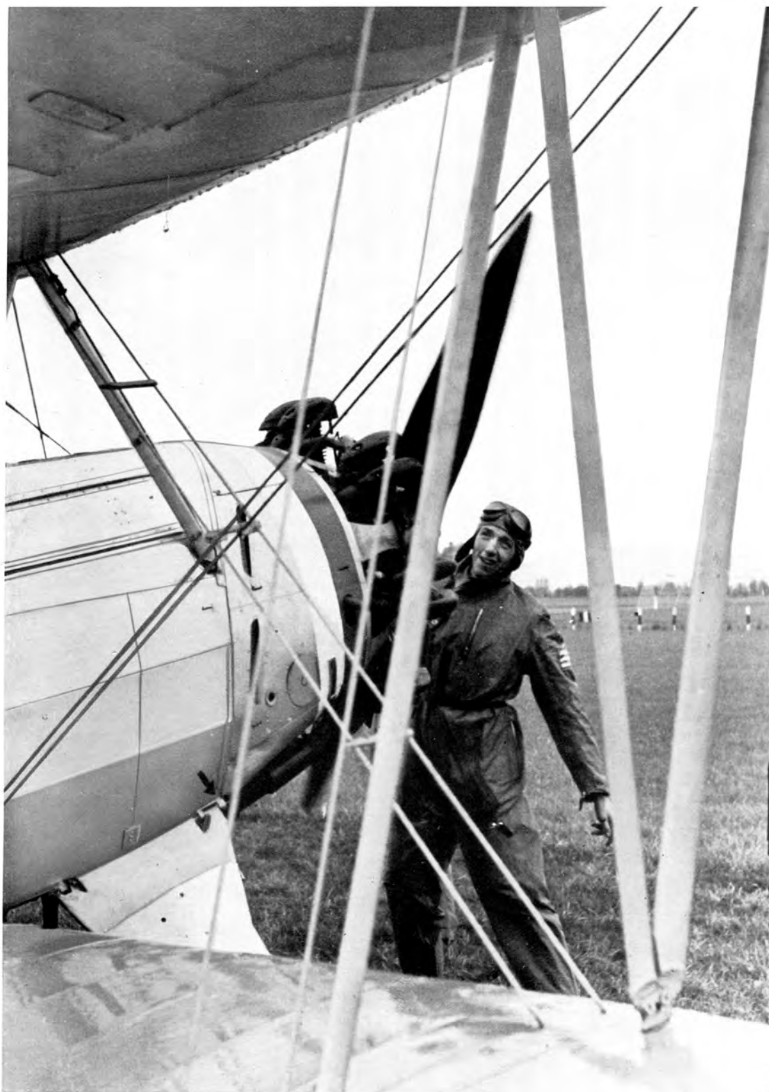
„Aus!“ ruft der am Steuer sitzende Flugzeugführer, und nun kann der Orter ohne Gefahr die Luftschraube durchdrehen. Auf „Frei!“ schaltet der Führer die Zündung wieder ein und läßt den Motor an.
