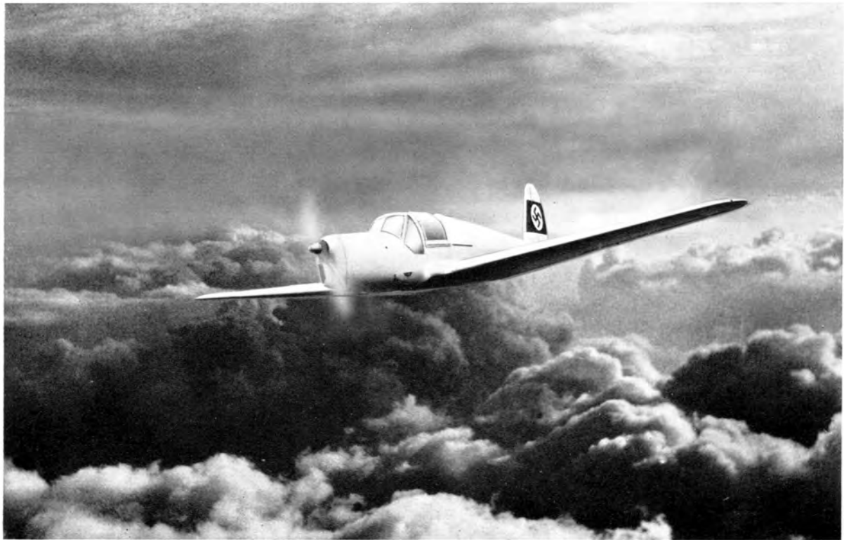
Das zweisitzige Reiseflugzeug Arado 79 mit einziehbarem Fahrwerk, das 1938 eine Reihe internationaler Rekorde aufstellte,
