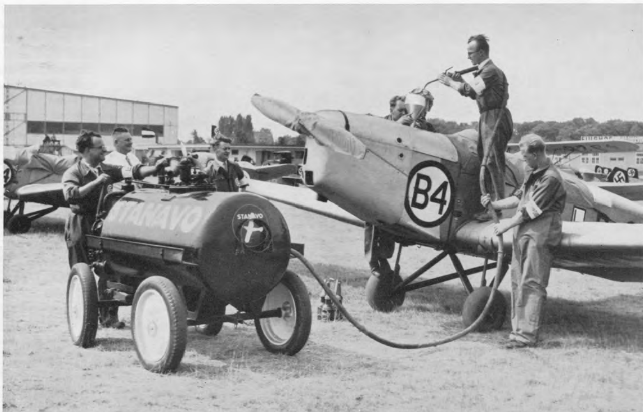
„Drei von der Tankstelle“ versorgen in ganz Deutschland den Tankdienst: Shell, Intava und Olex. Sie liefern: Benzin und Öl. Der Tankwagen rollt heran. Der Benzintank des Flugzeugs, hier ein Rumpftank, wird aufgeschraubt, der große Benzintrichter wird eingesetzt, und wehe, wenn der Lederlappen fehlt. Ein Tropfen Regenwasser, der die Düse verstopft, kann zur Notlandung führen. Bei jeder Tankung muß der Ölstand geprüft werden. Die Ölkannen stehen neben dem Tankwagen auf der Erde.
