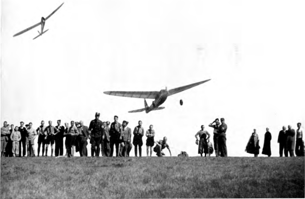
Flugzeugschlepp im kleinen. Ein Segelflugmodell wird von einem Benzinmotorflugmodell in die Höhe geschleppt. Das ist die neueste Startart für Modelle, die beim Reichswettbewerb 1938 zum erstenmal erfolgreich vorgeführt wurde.
