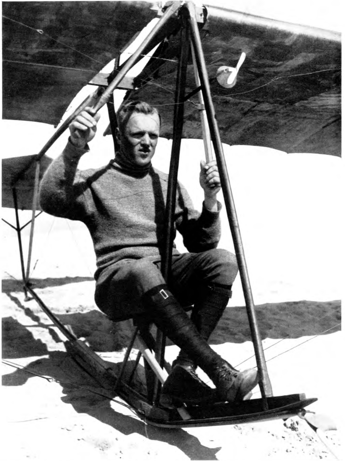
Auf einem kleinen Brettchen sitzend, beide Füße hintereinander auf die schmale Kufe gestützt, steuerte Ferdinand Schulz seinen „Besenstiel“ nicht mit einem stehenden Knüppel, sondern mit zwei an dem Flügelholm hängenden Steuerknüppeln, deren einer die Querruder, deren anderer das Höhenruder betätigte. Alles an seinem Flugzeug hatte er selbst hergestellt. Sogar den Geschwindigkeitsmesser, der durch eine kleine Luftschraube betätigt wurde.
