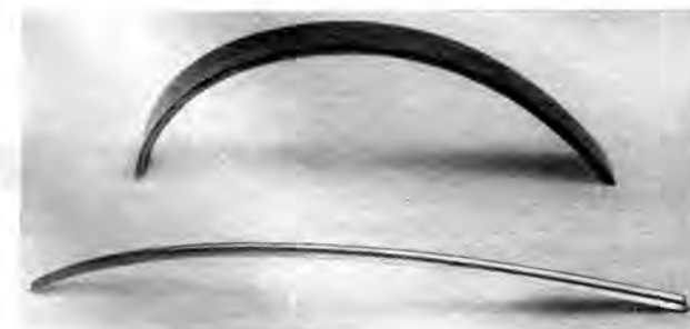
Abb. 2. Biegeschablone für Profilbänder und fertiges Profilband.
