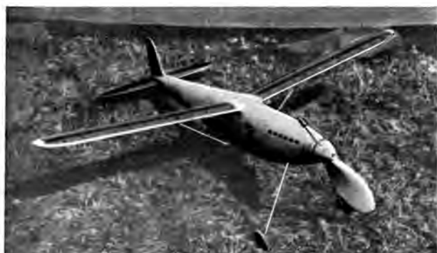
Abb. 7. Flugmodell mit Einblattluftschraube eines Belgiers.
