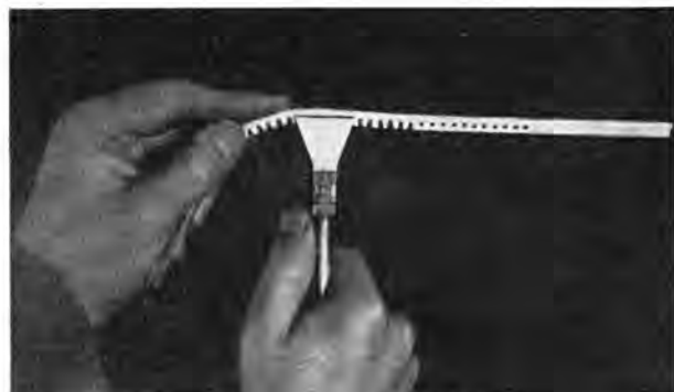
Abb. 7. Biegen des ausgesparten Profils 7.
