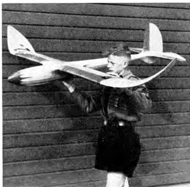
Abb. 14. Ausgezeichnete Flügel-Rumpf- und Leitwerk-Rumpf-übergänge am Segelflugmodell von Gustav Kahle.
