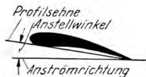
Abb. 33. Der Anstellwinkel ergibt sich aus der Anströmrichtung.
