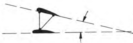
Abb. 36. Schränkung zwischen den beiden Tragflügeln eines Doppeldeckers.
