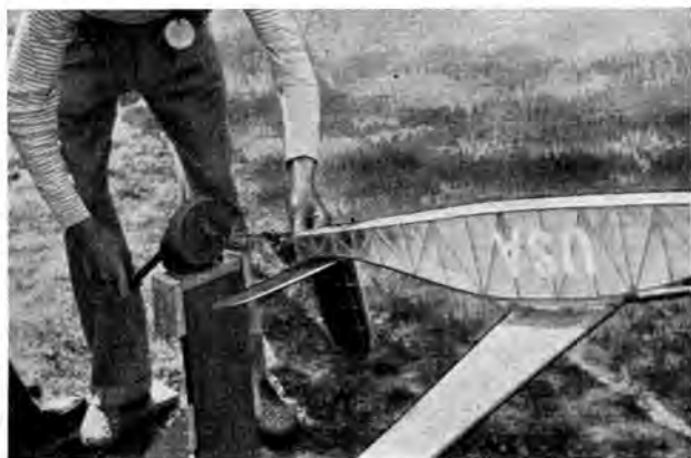
Abb. 11. Amerikanische Aufziehvorrichtung für den Gummimotor.
