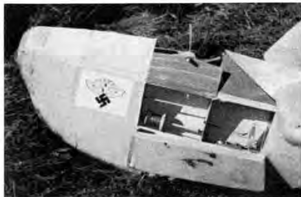
Abb. 11. Windrad-Kurvensteuergeräte für Thermifsegelflüge von Ebenböck.
