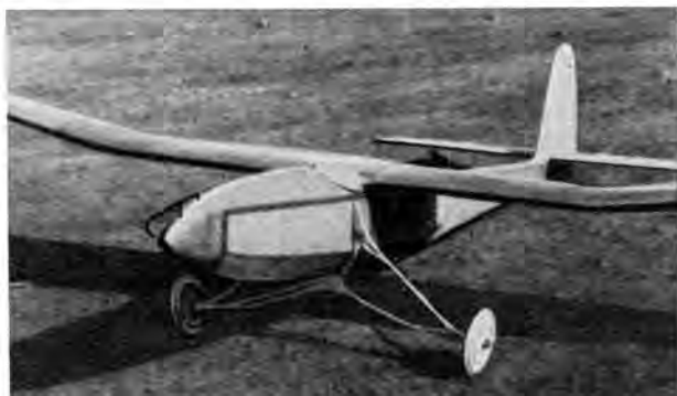
Abb. 1. Das Segelflugmodell mit Fahrgeßell und hochgelegtem Bugstarthaken.
