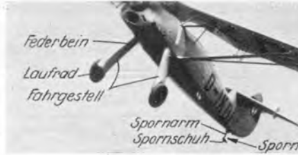
Abb. 10. Die Zusammensetzung des Fahrwerkes.
