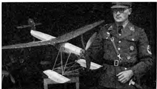
Abb. 11. Gegenläufige Luftschrauben am Flugmodell von Hoppe.
