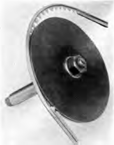
Abb. 7. Biegeschablone für Randbogen aus dem Profilband Nr. 7.
