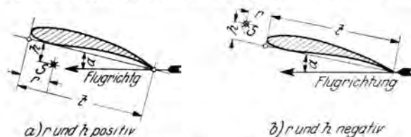
Abb. 12a und b. Positive und negative Schwerpunktsrödlage ( r/t ) und Schwerpunkthöhe ( h/t ). S = Schwerpunkt.
