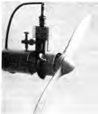
Abb. 1. Der äußere Aufbau des Motors „Kratmo 4“.
