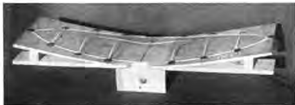
Abb. 4. Tragflügelhelling mit aufgeheftetem Tragflügel.
