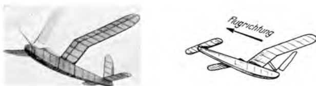
Abb. 12. Das schwingenangeriebene Flugmodell von Lippisch, links als normales, rechts als Entensflugmodell.
