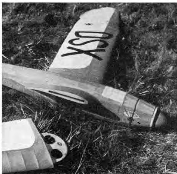
Abb. 12. Sich bewährende ausklipbare Flügelbefestigung am Flugmodell von Paul Adolph Richter.
