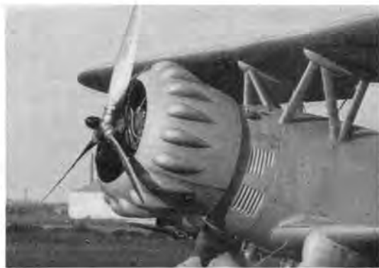
Abb. 39. NACA-Haube zur Verkleidung eines Sternmotors.
