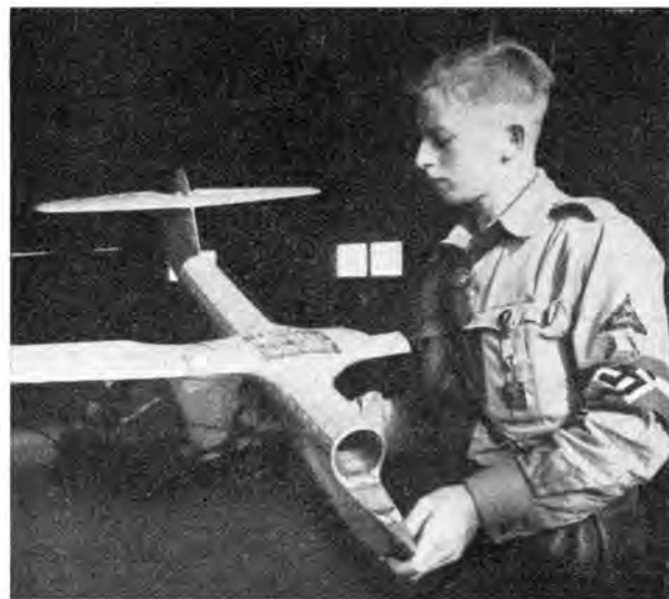
Abb. 8. Flugmodell von Alfred Kahle mit Kompaß-Düsen-Richtungssteuerung.
