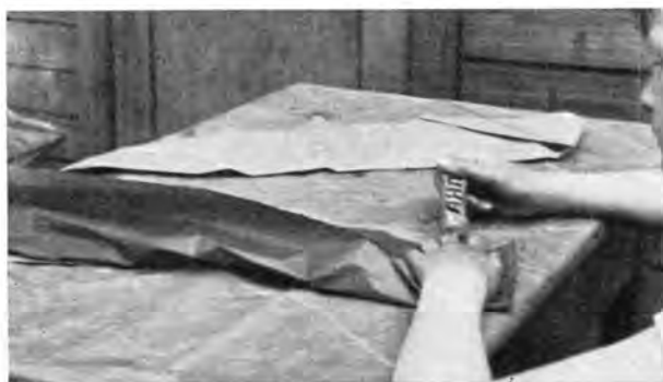
Abb. 5. Ebenso einfach ist das Umsalten u. Kleben der Längsnähte.
