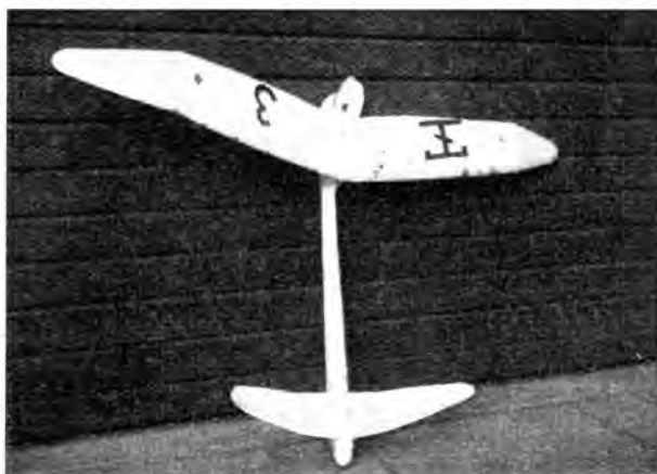
Abb. 15. Entenssegelflugmodell nach der Meco-Metallbauweise von Otto Bernicke.
