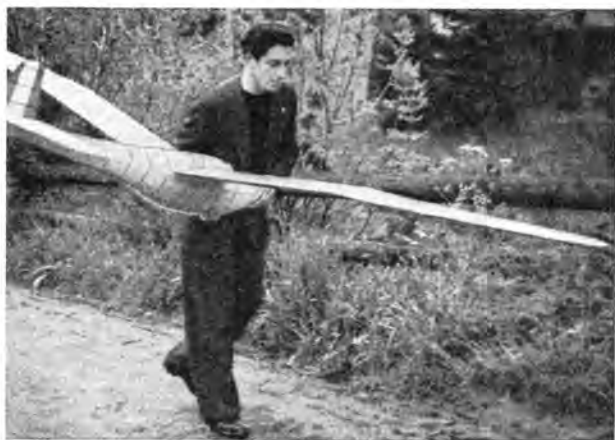
Abb. 3. Das aus Balsaholz gebaute und mit Seidenpapier ohne Imprägnierung bespannte Segelflugmodell des Italieners Mario Roderigo, Rom, wird im Lauffschritt durch den Regen zur Startstelle gebracht.
