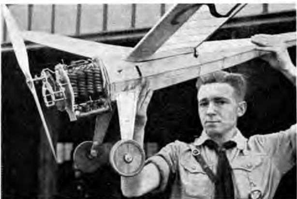
Abb. 2. Flugmodell mit Turbinenantrieb von Walch.
