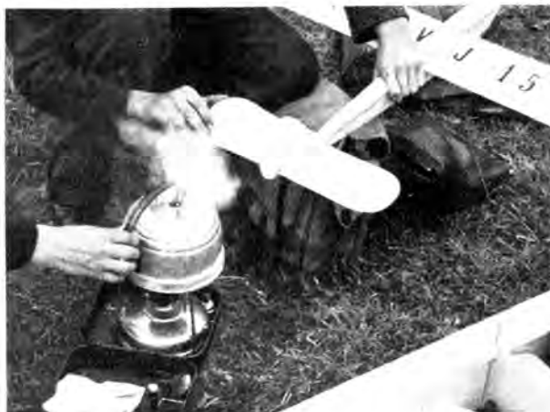
Abb. 5. Dampfanlage zum Biegen im Gelände.
