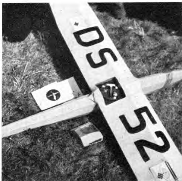
Abb. 7. Die Geräte der Doppelkompaß-Richtungssteuerung des Flugmodells von Heinz Emmerich.
