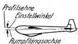
Abb. 32. Einstellwinkel eines Flugzeuges.
