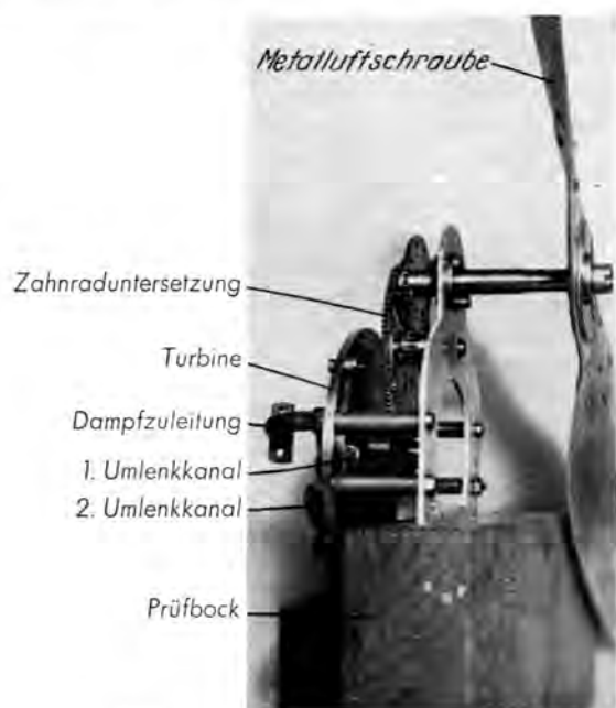
Abb. 1. Aufbau der Dampfturbine.
