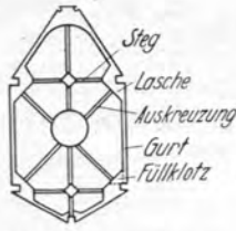
Abb. 8. Die richtigen Benennungen der verschiedenen Spanteinzelteile.
