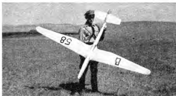
Abb. 16. Normales Metall-Segelflugmodell mit guten Flügel-Rumpfübergängen von Karl Werner.
