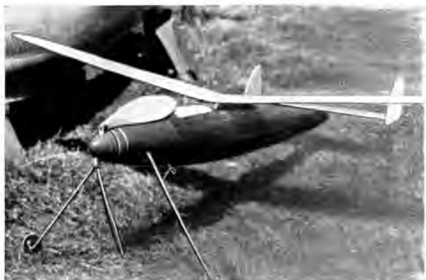
Abb. 9. Engl. Modell m. rückklappbaren Luftschraubenblättern.
