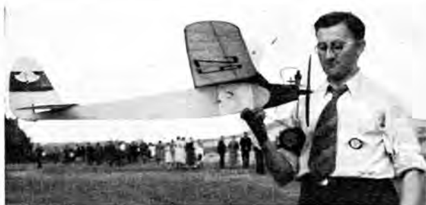
Abb. 8. Das Benzinmotorflugmodell von Krause, Dessau, wies einen akustischen Landeortanzeiger auf.
