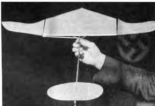
Abb. 5. Saalflugmodell des Enten-Baumusters mit Schwingen-antrieb von Lippisch.
