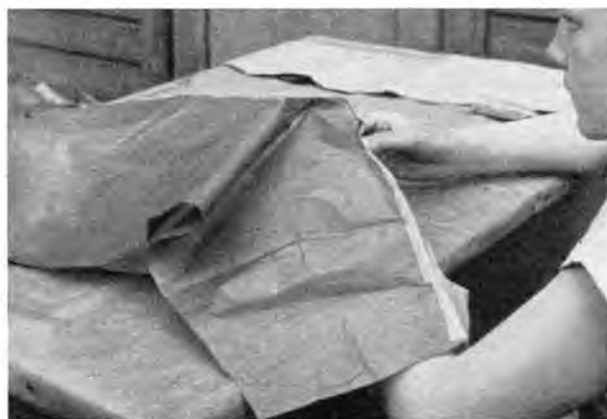
Abb. 6. Jede Klebenäht muß nach Fertigstellung geprüft werden. Sechs Klebenähte halten die Hülle zusammen.
