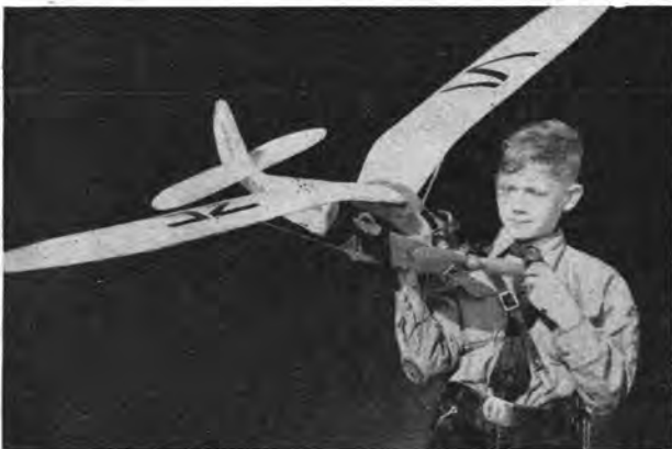
Abb. 19. Benzinmotor-Flugmodell des H.J.-Oberrottenführers Klinger, Müglitz (Mark). Spannweite 1540 mm, Motor „Kratmo 4“
