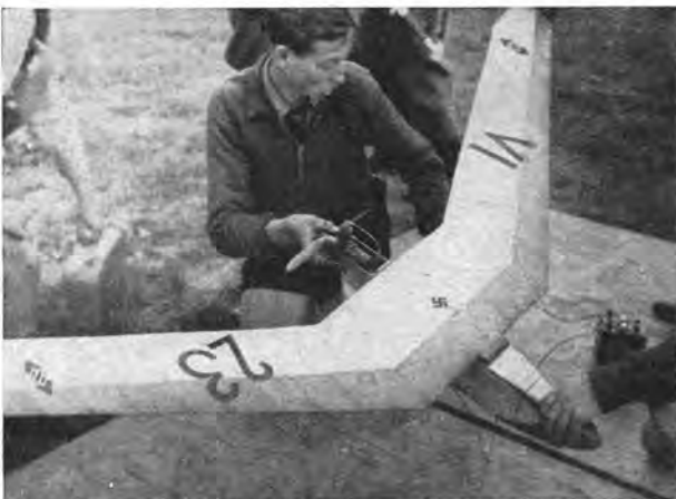
Abb. 20. Nurflügel-Benzinmotor-Flugmodell des Hitlerjungen König, Köthen. Spannweite 1700 mm, Motor „Kratmo 4“
