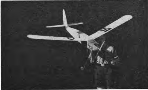
Abb. 18. Eigenentworfenes Benzinmotor-Flugmodell des Hitlerjungen Buchholz, Hannover. Spannweite 2200 mm, Motor „Kratmo 10“
