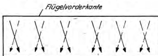
Abb. 2. Ablenkung der Luftströmung auf Ober- und Unterseite
