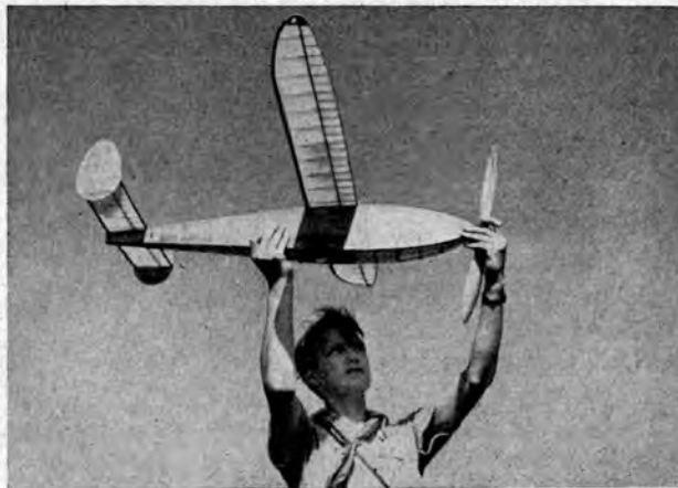
Abb. 2. Flugmodell mit Klappluftschraube und einziehbarem Fahrwerk
