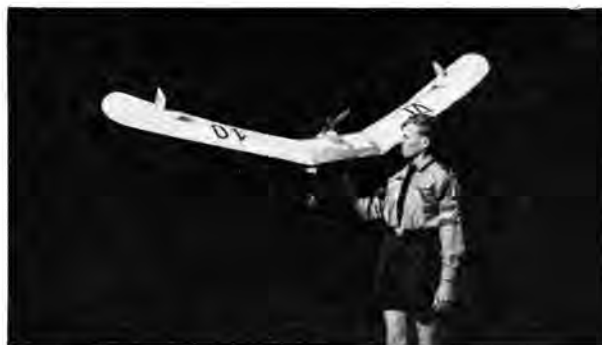
Abb. 21. Nurflügel-Flugmodell des Hitlerjungen Lambeck, Essen, Spannweite 2200 mm, Motor „Kratmo 10“
