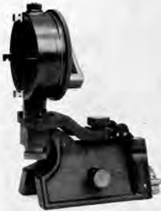
Abb. 12. Das Aufspanngerät mit Koordinatenring (etwa \frac{1}{4} nat. Größe).
