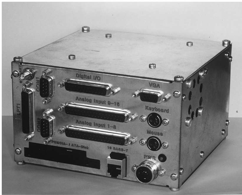
Abbildung 7.3: Flugmessanlage FMA-PC III für Segelflugzeuge
