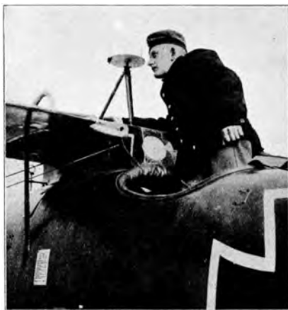
Abb. 234. Montage der Peilscheibe.
