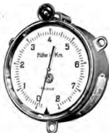
Abb. 92. Höhenmesser (Scholz), nämlich bei Tage die schwach gefärbte Radiumbelegung dunkler als ihr weißer Grund erscheint, findet bei Nacht das Gegenteil statt; in der Dämmerung tritt somit ein Zeitpunkt ein, wo die Beschriftung gänzlich verschwindet. Erfahrungsgemäß werden gerade in
