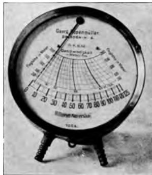
Abb. 266. Staudruck-Fahrtmesser mit Höhenkorrektur (Rosenmüller).
