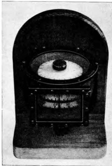
Abb. 217. Trommelkompaß (Ludolph) nach Dr. Neuber.
