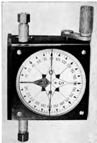
Abb. 220b. Selenkompaß, stellbare Rose (Bamberg).
