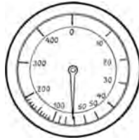
Abb. 42. Fehlerhafte Skala einer Schwimmeruhr,
