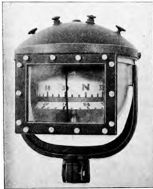
Abb. 216. Trommelkompaß (Ludolph) nach Dr. Neuber.
