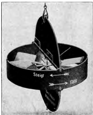
Abb. 161. Vertikalanemometer nach Prof. Precht (Dr. Hase).
