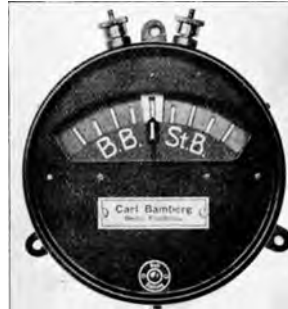
Abb. 220c. Selenkompaß, Nullzeiger (Bamberg).
