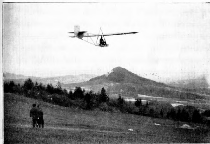
Abb. 6. Einheitsschulmaschine „Grunau 29“. Entwickelt aus der Espenlaub-Schulmaschine.
