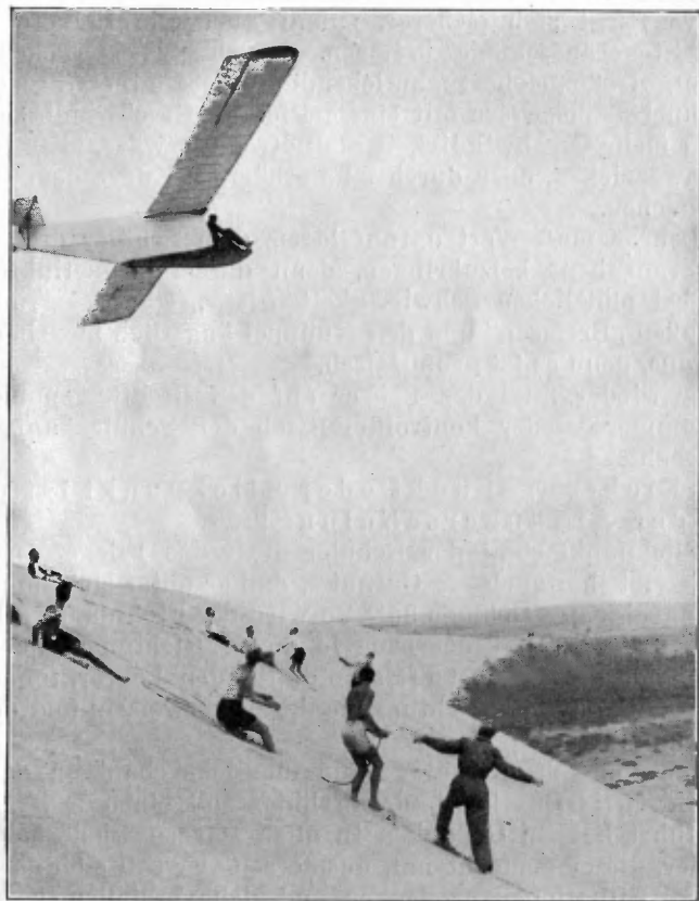
Abb. 13. Verkleideter „Zögling“ der R. R. G. in der Startkurve. Beginn des typischen Hangsegelfluges.
