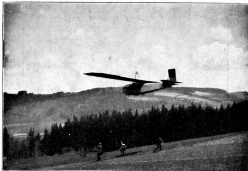
Abb. 12. Einheits-Segelschulmaschine „Grunau“ kurz nach dem Start.
