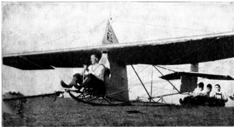
Abb. 2. „Stahlrohr-Zögling“ (verkleidet) fertig zum Start.
