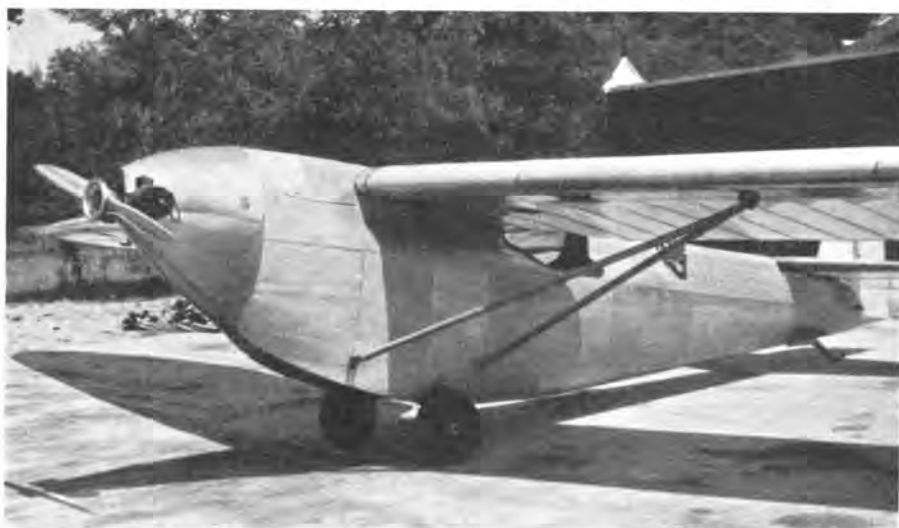
Abb. 365. Motorsegler „Maikäfer“ mit Möller-Motor.
