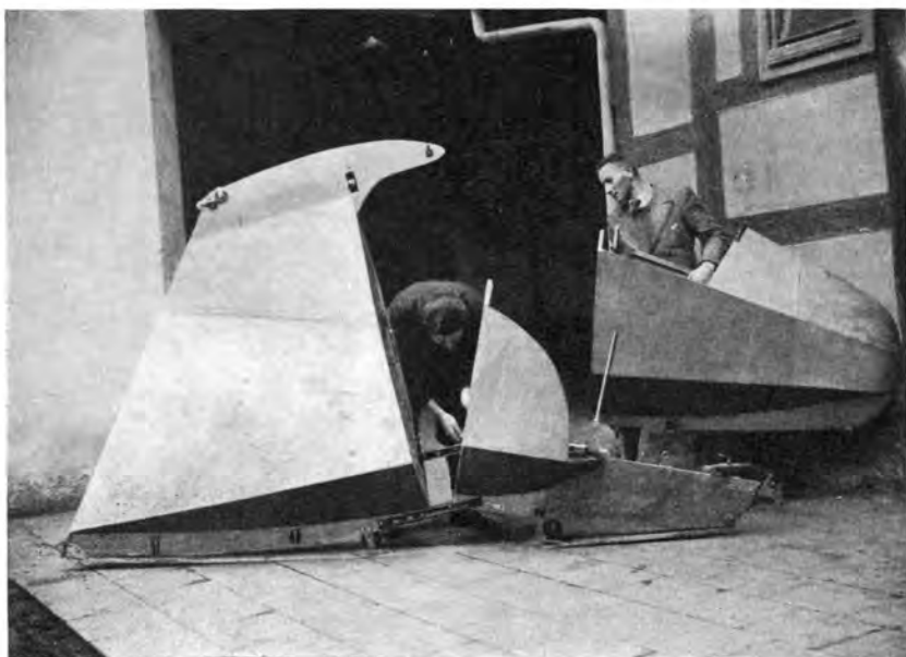
Abb. 353. Zusammenbau des Spannturmes der „Mösch“ mit dem vorderen Rumpfteil und der Verkleidung.
