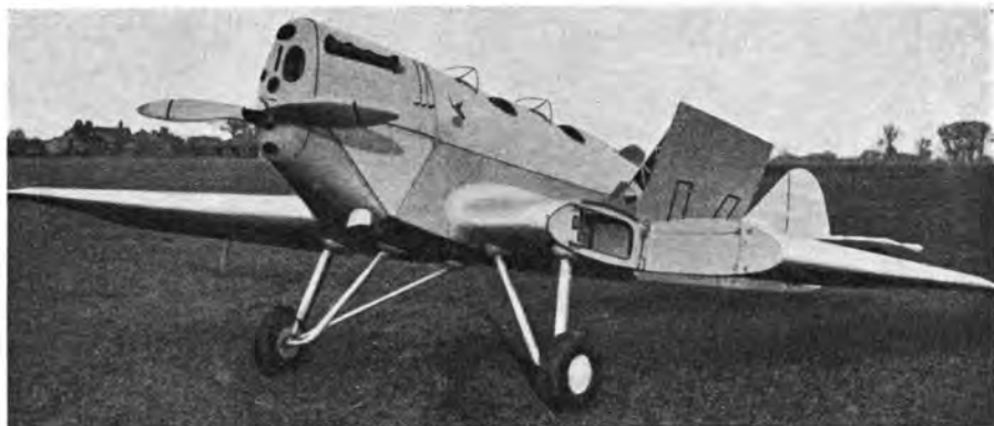
Abb. 271. Der „Miles Hawk“ mit zurückgeklapptem Flügel.
