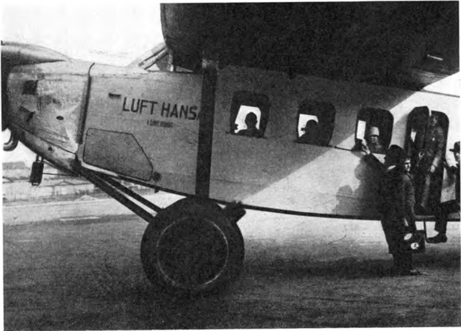
Abb. 104. Fahrwerk der Gotha-Wulf „Möve“.
