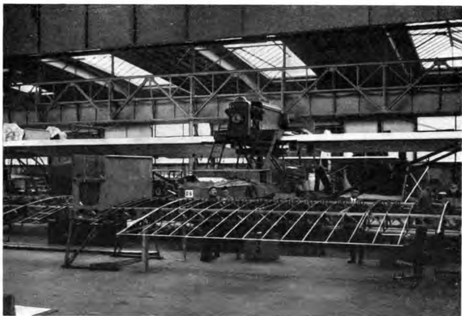
Abb. 115. Dornier-Flügel im Bau.
