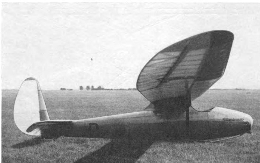
Abb. 359. Espenlaub-Hochleistungs-Segelflugzeug „E 32“. Spannweite 13 m, Länge 6 m, Fläche 16 m 2 ; Leergewicht 110 kg.
