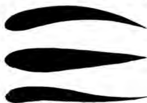
Abb. 30–32. Oben: Normales Profil. Mitte: Symmetrisches Profil. Unten: Profil mit aufgezogener Hinterkante.
