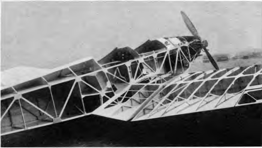
Abb. 70. Holzrumpf des Klemm-Eindeckers.
