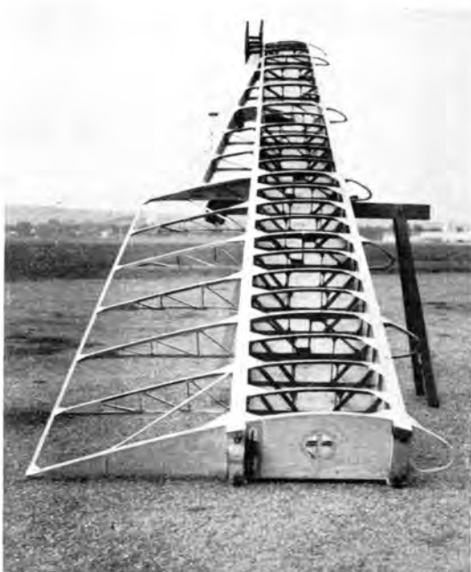
Abb. 114. Fläche des Klemm-Eindeckers in Holzbauweise.
