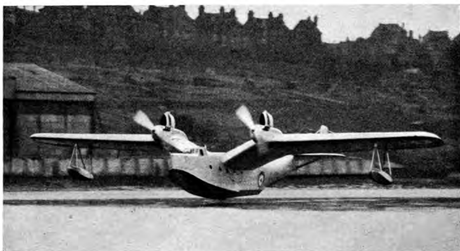
Abb. 302. Short-Flugboot R 24/31, Spannweite 28 m, Fluggewicht 8500 kg.
