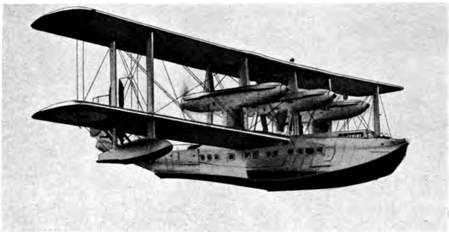
Abb. 303. Short R 6/28 mit 3 Rolls-Royce „Bullard“-Motoren.
