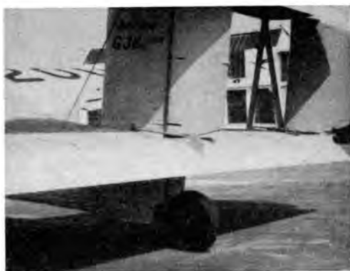
Abb. 106. Steuerbares Schwanzrad der Junkers G 38.
