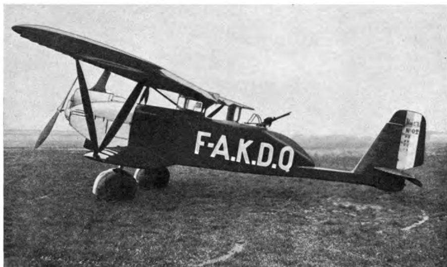
Abb. 307. Breguet 27 mit 500 PS Renault 12 Ic.
