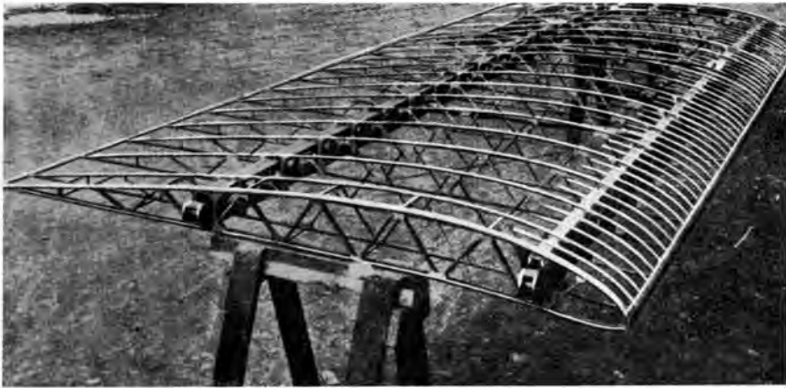
Abb. 116. Dornier-Fläche für Stoffbespannung.
