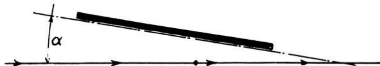
Abb. 5. \alpha = Anstellwinkel der ebenen Platte.
