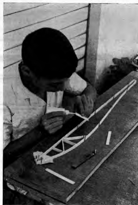
2 - Collage (Fuselage poutre)
