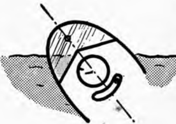
FIG. 43. — Virage à gauche à grande inclinaison (45°), cabré et dérapé (position très dangereuse).
