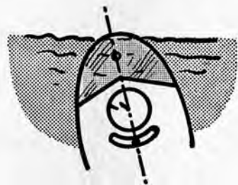
FIG. 29. — Virage à gauche à faible inclinaison, piqué. Bille au milieu, inclinaison correcte.
