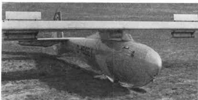
Bild 20. Segelflugzeug „Rhönbussard“ mit ausgefahrenen „Bremsklappen“, die den Auftrieb zum Teil vernichten und dadurch die Sinkgeschwindigkeit erhöhen
