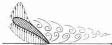
Bild 12. Jeder Tragflügel verliert bei einem bestimmten Anstellwinkel, der vom Profil abhängig ist, einen großen Teil seines Auftriebs, während der Widerstand stark wächst. Die Strömung „reißt ab“
