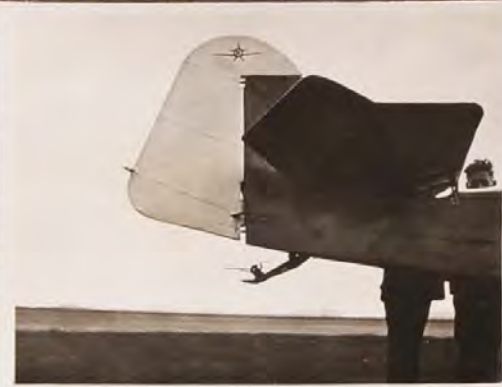
Bild 215. Startmethoden: Moderne Vorrichtung für Schlepptaubefestigung am Schwanzsporn
