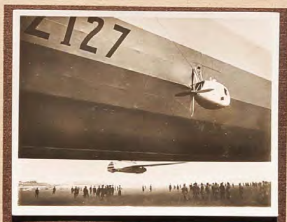
Bild 219. Startmethoden: Segelflugzeugstart vom Zeppelin
