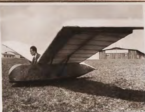
Bild 19. Rhön 1922: Schwanzloser Versuchsbaustück der Weltensegler-Werke
