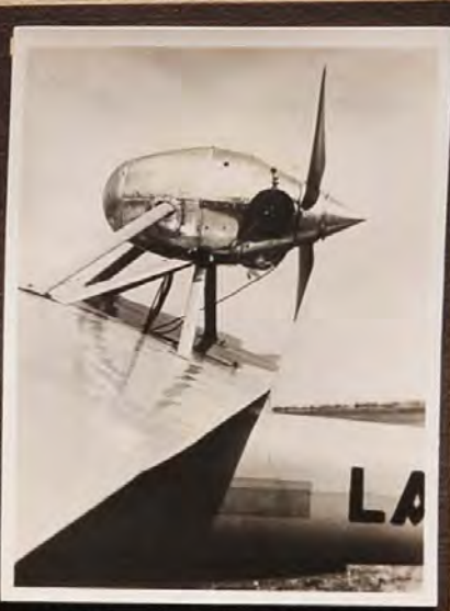
Bild 168. Segelflugzeuge mit Hilfsmotor: Der Außenbord-Motor des Segelflugzeuges
