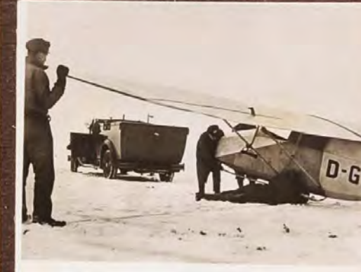
Bild 210. Startmethoden: Die Verbindung zwischen Schleppauto und Flugzeug wird hergestellt
