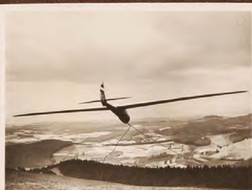
Bild 208. Startmethoden: Vor dem Abfallen des Startseiles
