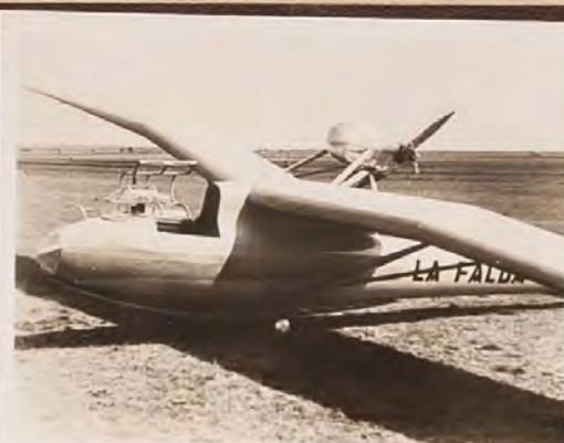
Bild 166. Segelflugzeuge mit Hilfsmotor: »La Falda«, der erste Motorsegler mit abnehmbarem Motor
