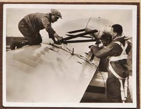
Bild 164. Segelflugzeuge mit Hilfsmotor: Einbau des Hilfsmotors
